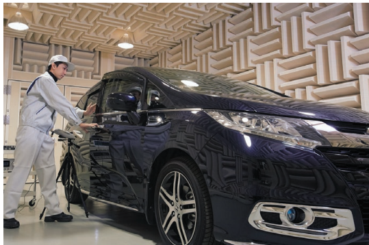
ドア閉音を無響室で確かめる、心理音響技術を用いた解析実験の様子。(三井金属アクト)
